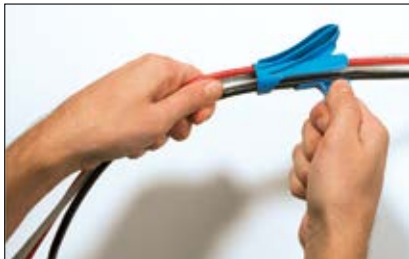
Asenna yksi tai useampi kaapeli työkaluun.
