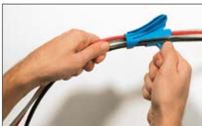
Aseta yksi tai useampi kaapeli työkaluun.
