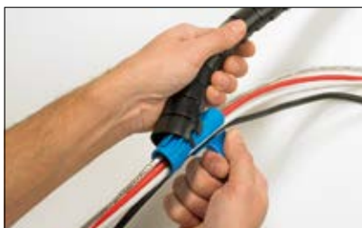
Aseta asennustyökalu Helawrap-sidontaspiraalin toiseen päähän.
